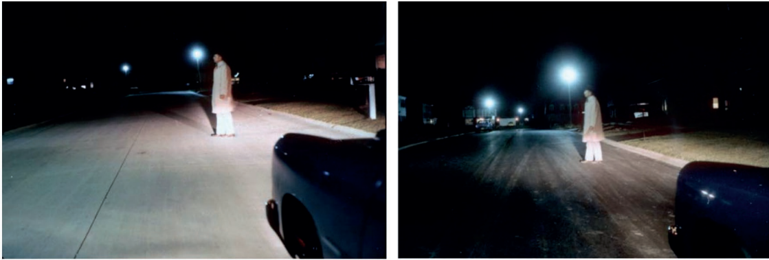
Рисунок 1 — Світловідбиваючі властивості цементобетонного (зліва) та асфальтобетонного покриття (справа)
