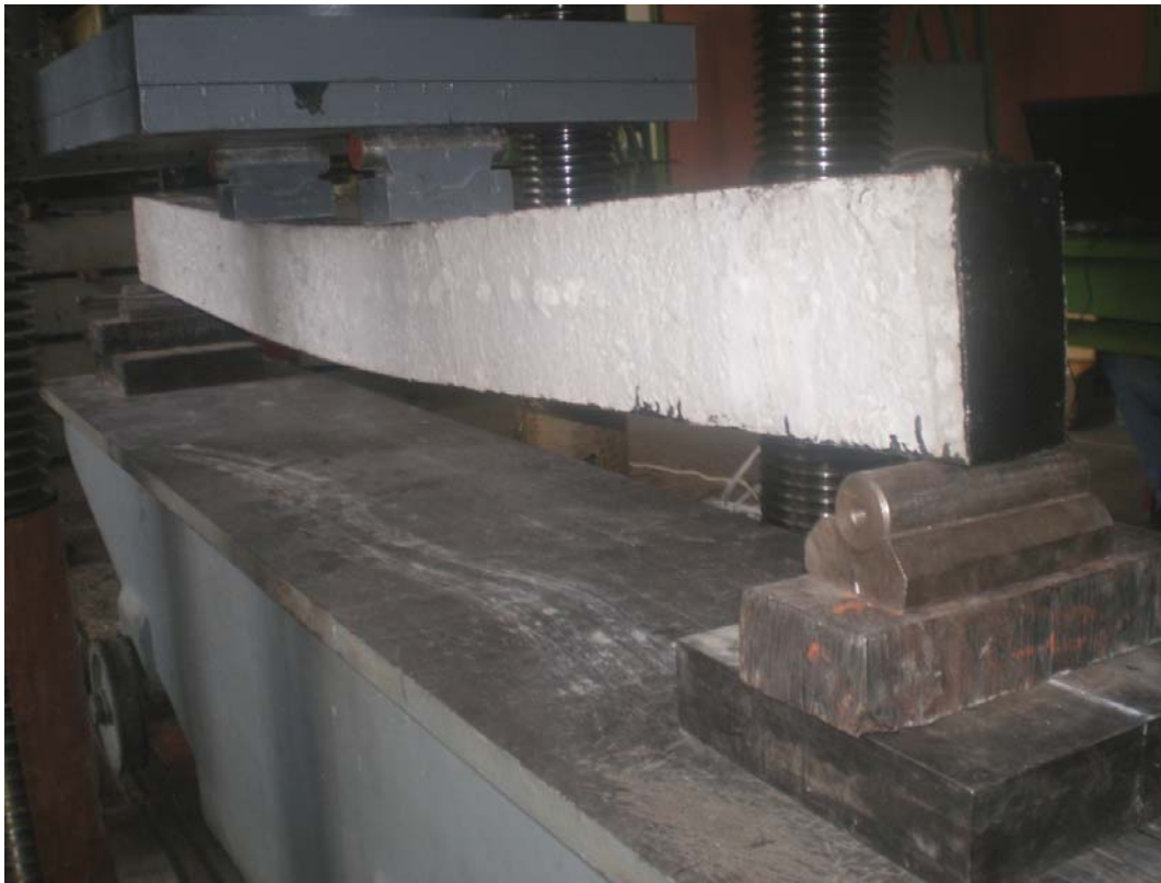
Рис. 5. Характер деформування балок
