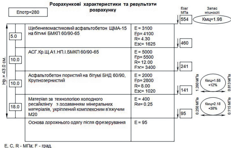
Рисунок 2 — Результати розрахунку конструкції дорожнього одягу (варіант 1)
