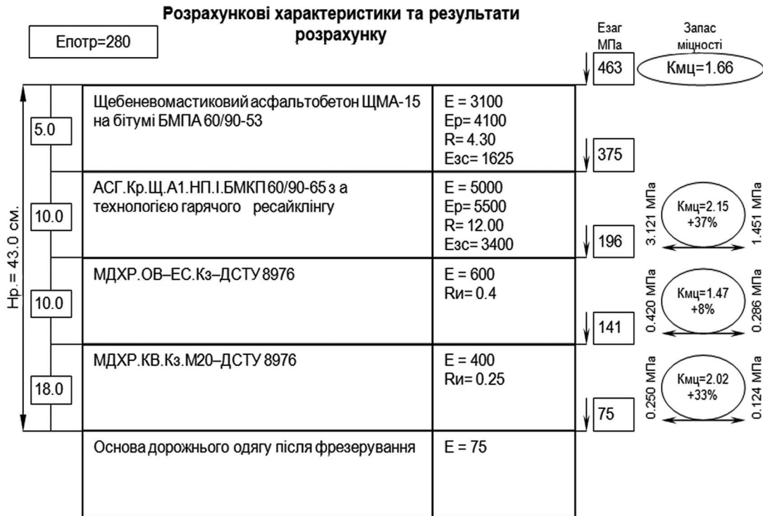
Рисунок 4 — Результати розрахунку конструкції дорожнього одягу (варіант 3)
