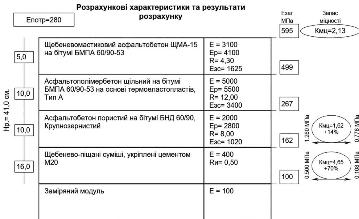
Рисунок 3 — Результати розрахунку конструкції дорожнього одягу (варіант 2)
