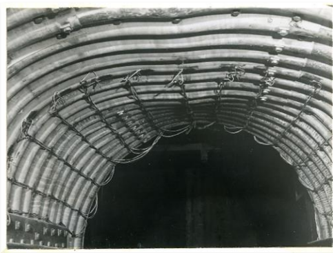
Рисунок 2 — Переміщення склепіння у формі напівкруглої арки з гофрованого металу під ґрунтовою засипкою від вертикального навантаження під час випробувань
