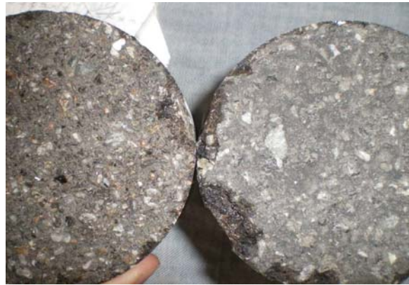
Рис. 4. Керни з асфальтобетонного покриття а/д Феневичі-Бородянка-Макарів-Бишів з матеріалом Дізол та без нього
