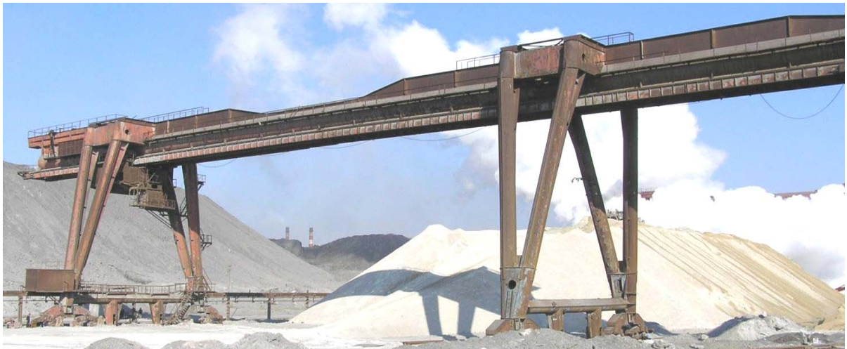
Рис. 1. Решетчатый (верхний) и трубчатый мостовые краны-перегрузатели
