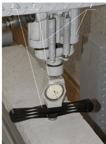
Рисунок 3 – Залізобетонна балка на стенді низькошвидкісного навантаження
