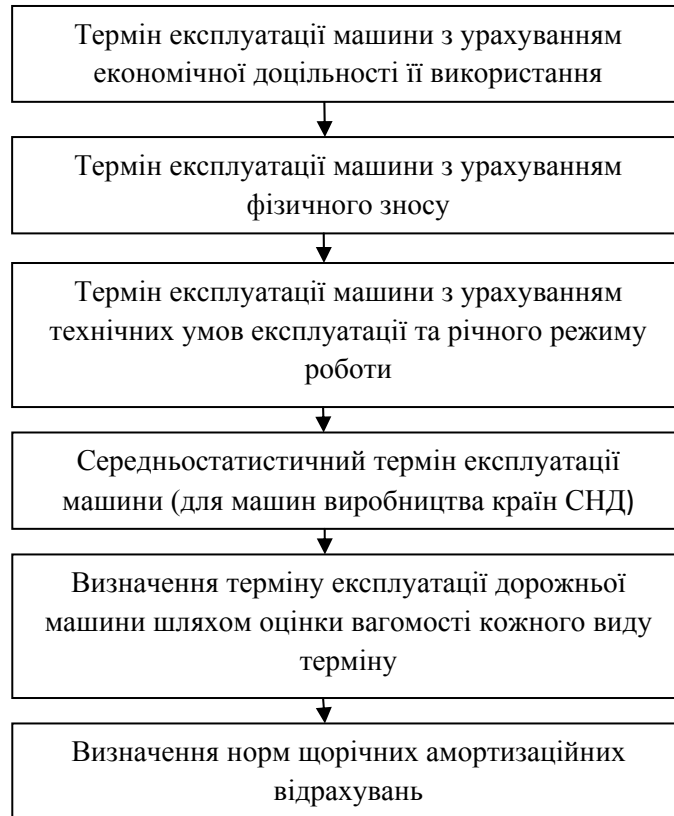
Рис. 2. Порядок визначення терміну експлуатації дорожніх машин та механізмів і норм їх амортизації
