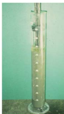
Рис. 3. Визначення водовідділення цементного розчину з урахуванням фільтруючого ефекту арматурного стрижня
