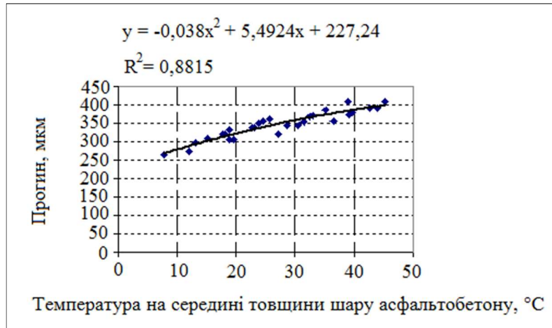
Рисунок 2 — Залежність прогину нежорсткого дорожнього одягу із шарами асфальтобетону від температури для постійної локації випробувань, визначена впродовж року, згідно з [1]
