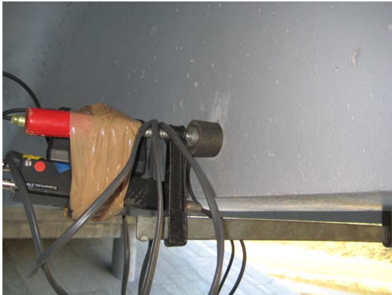
Рис. 3. ПАЕ, встановлений на поверхні бетону балки Б-2 по середині прогону 1-2
