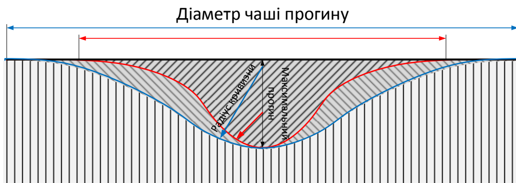
Рисунок 1 – Профілі деформації дорожніх конструкцій
