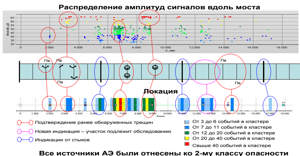
Рис. 1. Сравнение локационной картины, графика распределения амплитуд вдоль координаты локации и результатов предыдущего обследования
