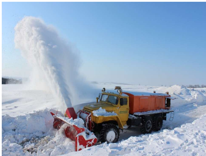
Рисунок 3 — Приклад роботи шнекороторного снігоочисника після завершення екстремальних погодних умов у зимовий період
