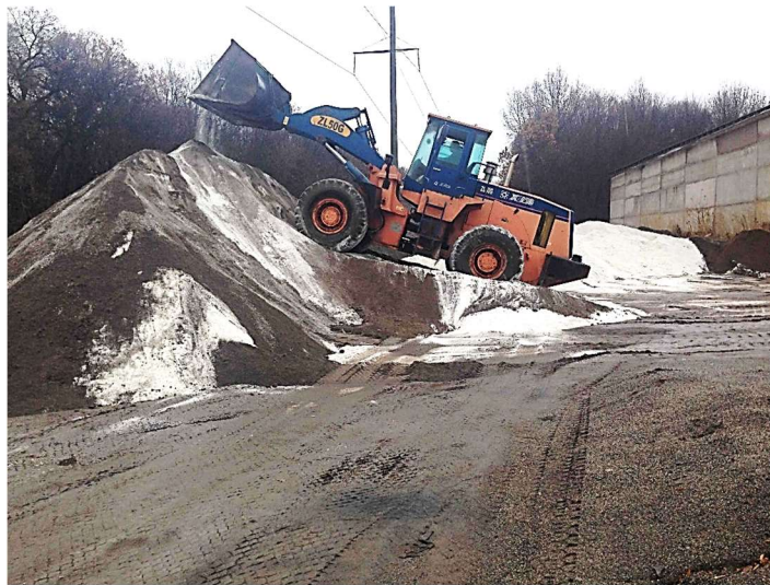
Рисунок 4 — Процес змішування технічної солі з фрикційними матеріалами на місці безпосередньо зберігання протиожезедної суміші
