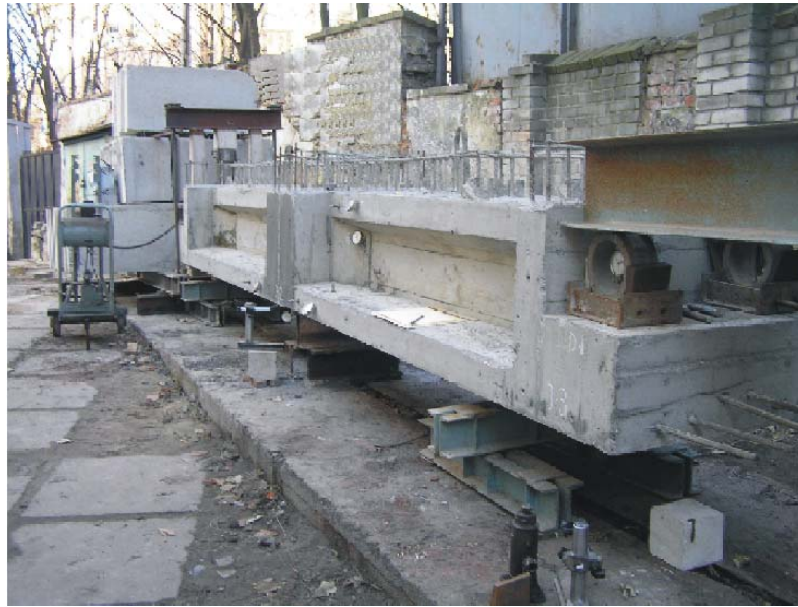
Рис. 7. Загальний вигляд досліджуваної конструкції балки монолітної ділянки, підготовленої до випробувань на стенді
