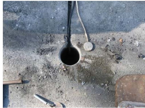
Рис. 2. Закладка датчиків вертикальних напружень у конструкцію дорожнього одягу на стенді
