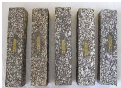
Рис. 7. Асфальтобетонні зразки з тензодатчиками
